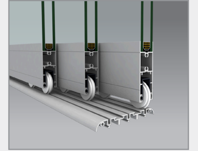
3-c Nolu Eşiksiz Alt Ray Detayı Nr. 3-c Details of Lower Rail with no Windowsill
